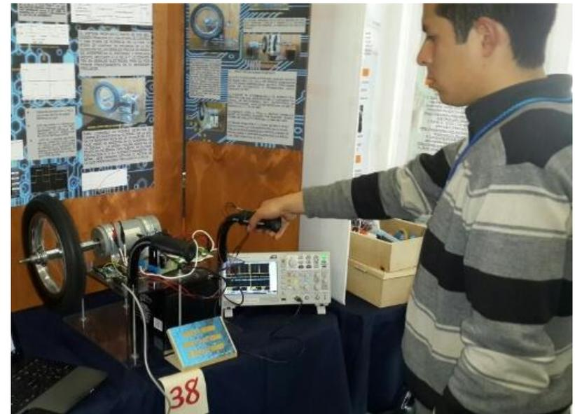
La figura muestra la conexión de los dispositivos requeridos para el control del circuito de potencia (puente H), que permite activar un motor de CD mediante la señal del encoder de cuadratura y proporcionar así una tracción a la silla.
