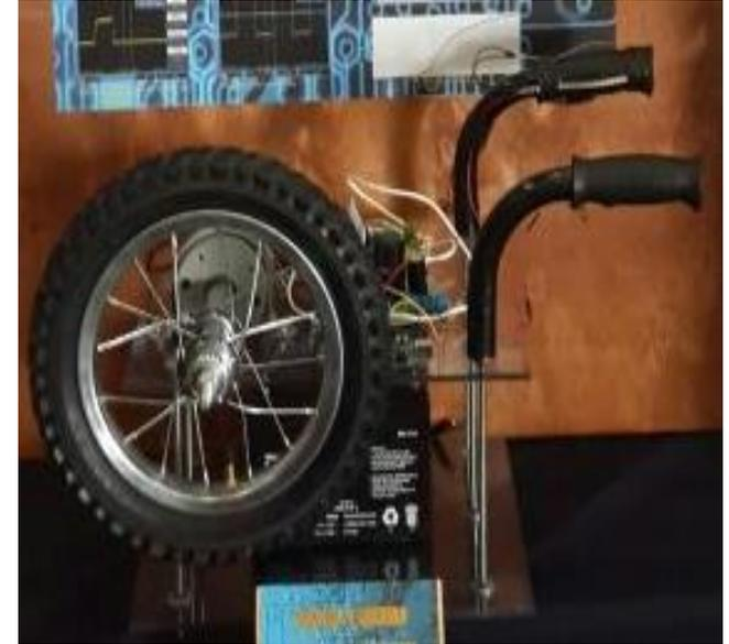
El control de este sistema puede darse en ambos sentidos de giro (enfrente-atras), llevando acoplado a una de las ruedas de la silla un encoder de cuadratura, teniendo dos salidas que al mismo tiempo generan ondas cuadradas que se defasan entre si según el sentido de desplazamiento de las ruedas.
